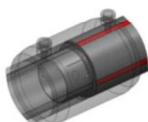
Втулка токопроводящая для соединения токопроводящих слоев трубы, устанавливается перед сваркой внутри свариваемых отрезков трубы под электросварной муфтой
