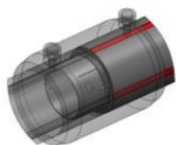
Втулка токопроводящая для соединения токопроводящих слоев трубы, устанавливается перед сваркой внутри свариваемых отрезкой трубы под электросварной муфтой
