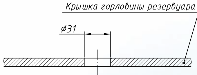
Рисунок 10 – Посадочное место для ДПУ контрольный без фланца
